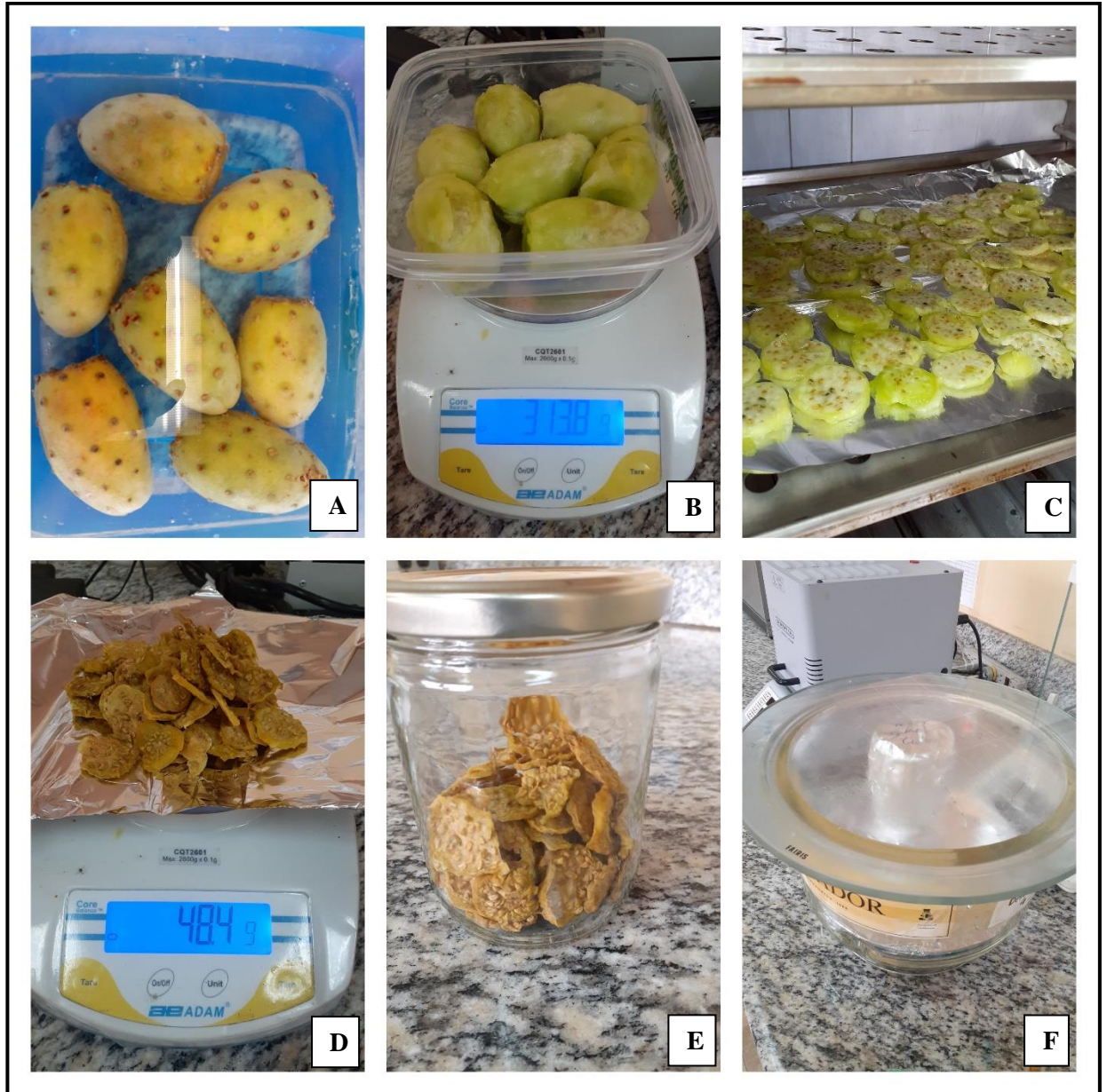
Figura 16. Acondicionamiento de la muestra para el desarrollo experimental A: Recepción y clasificación de MP (tuna blanca) B: Pelado y desinfección C: Proceso de secado en estufa a 60 °C por 24 horas D: Toma de peso final de muestras secas E: Envasado de la muestra en frasco de vidrio F: Almacenamiento (desecador) de envase de vidrio, cubierto con papel aluminio
