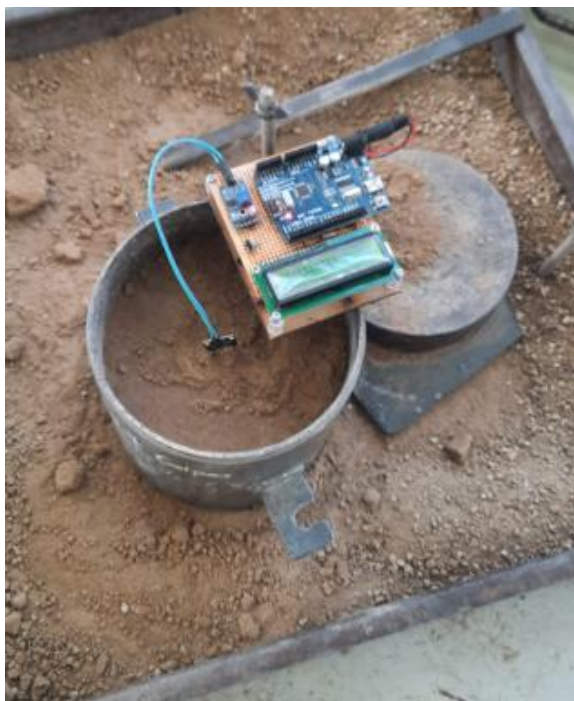
Fig. 31 Contenido de humedad (Densidad de Campo - Sensor Resistivo) Realizado: R. D. Villacrés Chérrez
