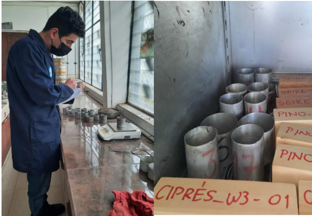
Fig. 24 Contenido de Humedad.
