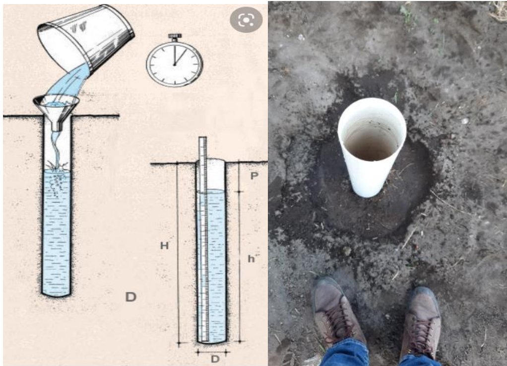
Fig. 22 Permeabilidad (Método de Lefranc: Somero de flujo variable descenso)
