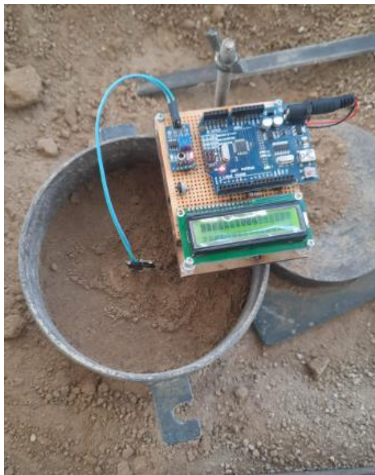
Fig. 29 Contenido de humedad (Proctor Modificado - Sensor Resistivo) Realizado: R. D. Villacrés Chérrez
