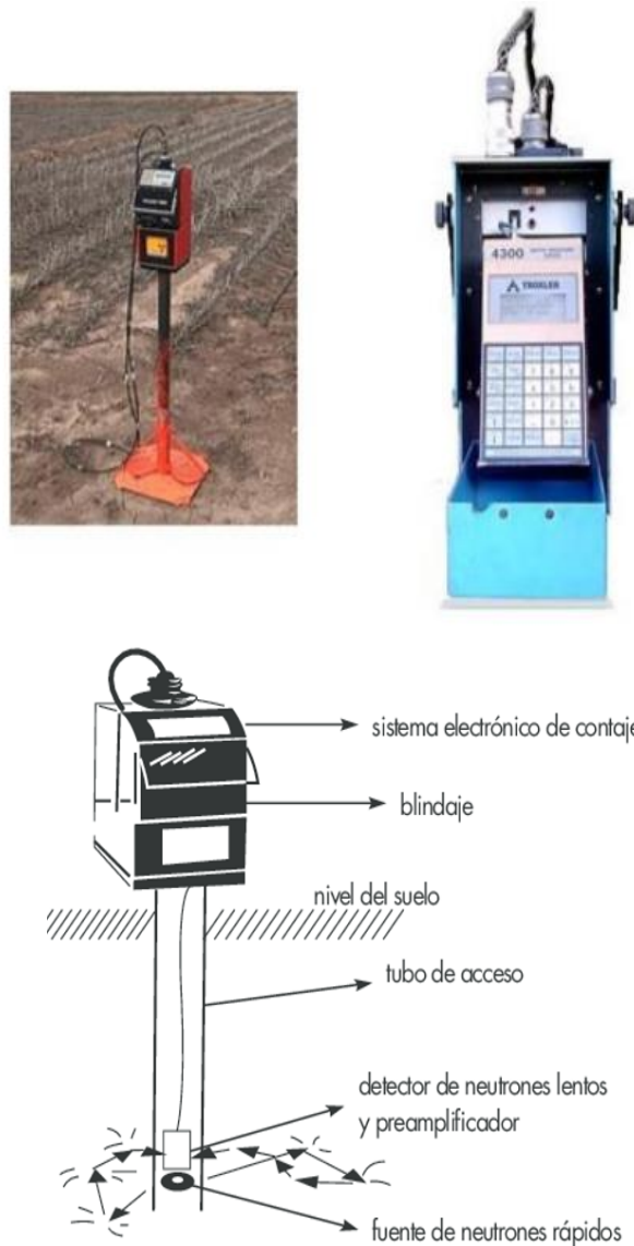
Fig. 3 Sonda de Neutrones.
