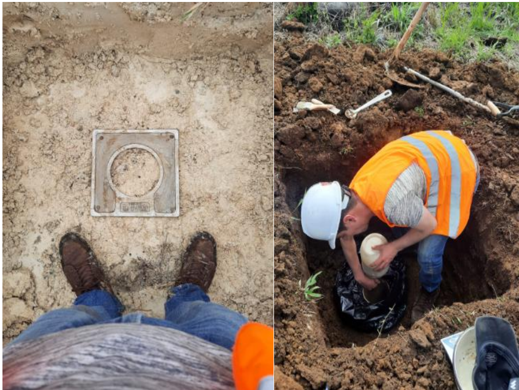
Fig. 21 Densidad de Campo (Método del cono y arena de Ottawa) Realizado: R. D. Villacrés Chérrez
