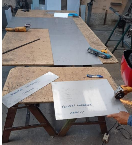
Figura 23 Preparación y corte de las planchas de acero AISI 304
