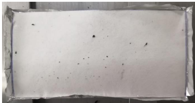
Figura 49 Papel filtro empleado en el ensayo de MDF
