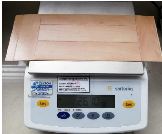
Figura 41 Pesaje del material del piso vinílico
