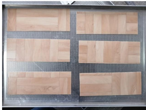
Figura 42 Material piso vinílico PC-E01 acondicionado
