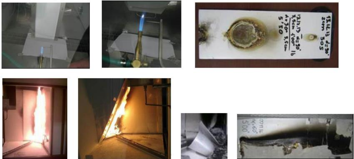
Figura 1 Ensayo de muestras de materiales de sistemas fotovoltaicos [2]
