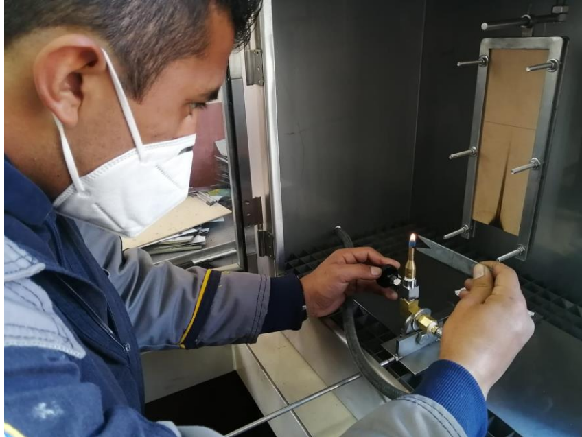
Anexo 1: Calibración del tamaño de la llama
