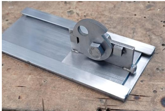
Figura 36 Ensamblaje del mecanismo de regulación del ángulo de aplicación y desplazamiento del quemador
