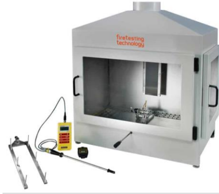
Figura 6 Esquema general de la cámara de combustión de fuente de llama única[14]
