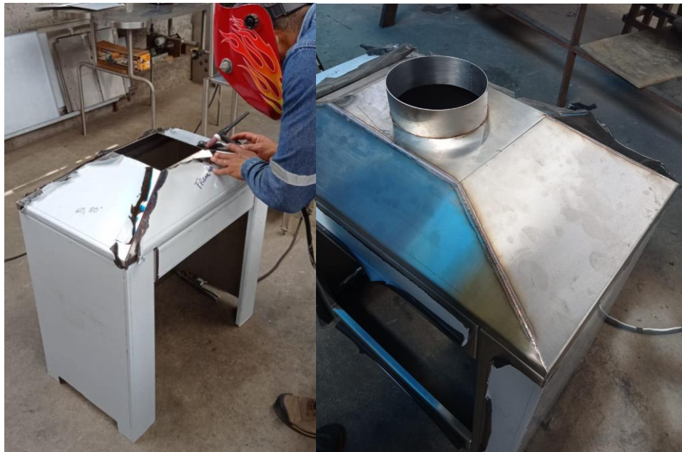
Figura 30 Armado del resto de elementos de la cámara de combustión
