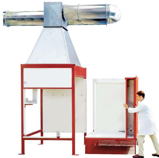
Figura 5 Esquema general de la cámara de combustión de ítems individuales [14]
