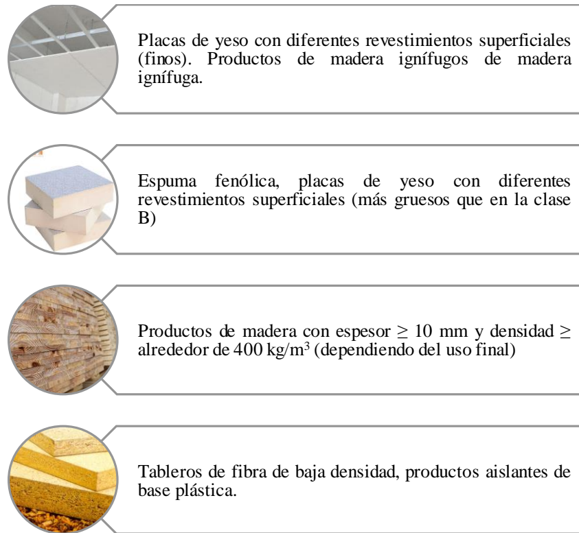
Figura 4 Ejemplos de los materiales que aplican para los ensayos de inflamabilidad de la norma ISO 11925 – 2 [14]
