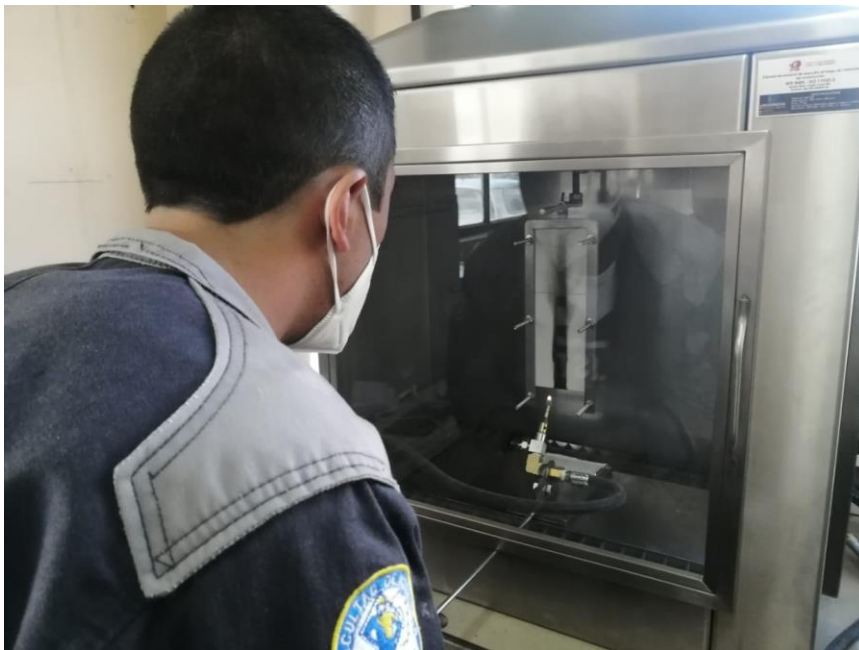
Anexo 1: Calibración del tamaño de la llama
