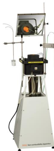
Figura 9 Esquema general del equipo para ensayos de incombustibilidad [14]
