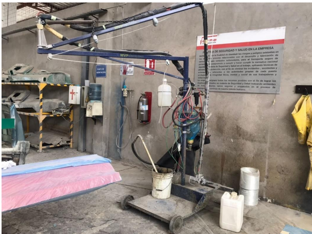
Figura 17: Aspersor de fibra de vidrio de la empresa VARMA S.A.
