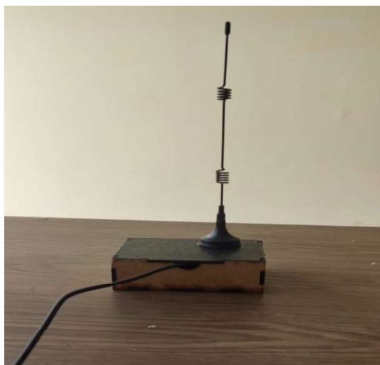
Fig. 20: Implementación del Gateway LoRa
