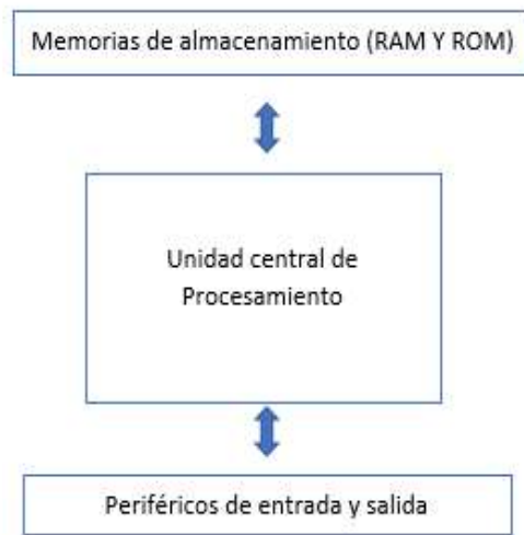
Fig. 2: Estructura interna de un microcontrolador.
