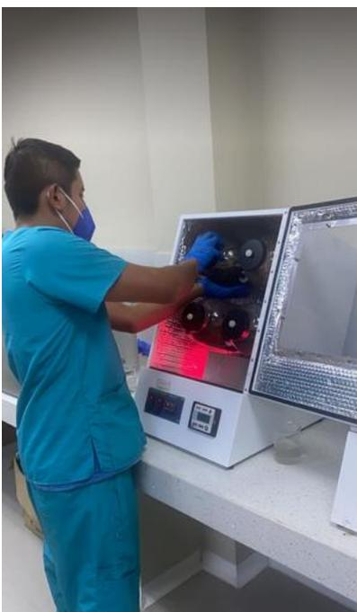
**Figura 10.** Incubación de muestras en equipos Daisy<sup>II</sup>
