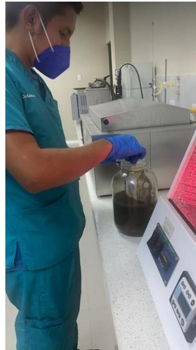
**Figura 9.** Colocación de bolsitas en equipos Daisy<sup>II</sup> para degradación y digestibilidad *in vitro* de nutrientes
