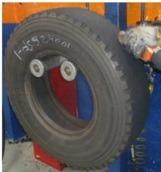
Figura 26. Proceso de escariado
