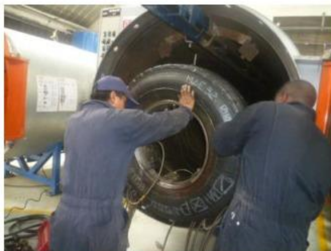
Figura 32. Proceso de vulcanizado
