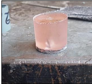
Figura 3-15: Muestra encapsulada con resina de poliéster + acelerante.
