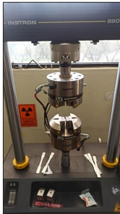
Figura 3-11: Máquina universal para ensayo de tracción.
