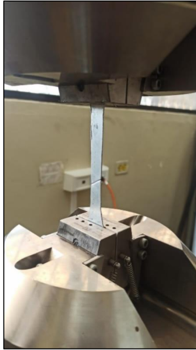
Figura 3-12: Ensayo de tracción.
