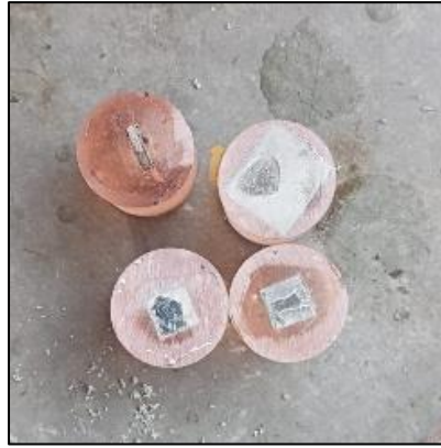
Figura 3-16: Muestras encapsuladas listas para lijar y pulir.
