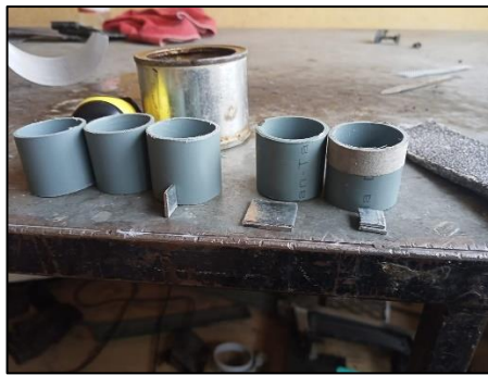
Figura 3-14: Muestras cortadas del perfil de SF listas para encapsular.
