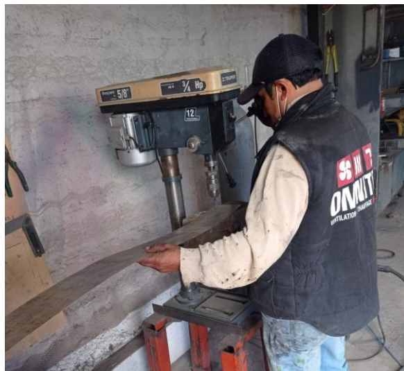
Figura 25: Proceso de perforado.
