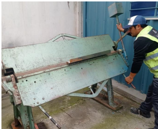
Figura 23: Proceso de doblado.
