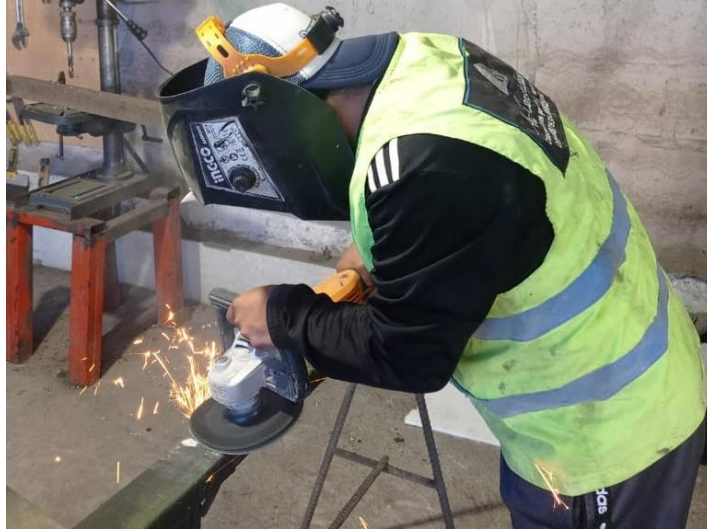
Figura 24: Proceso de pulido.
