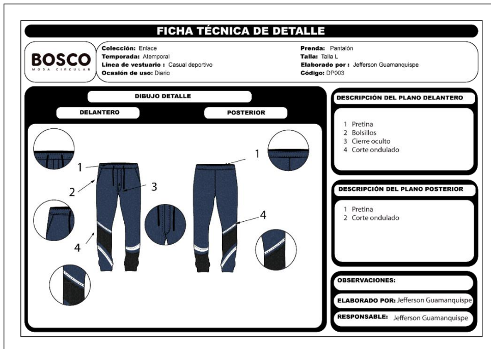
Figura 67: Ficha Técnica de Detalle DP003
