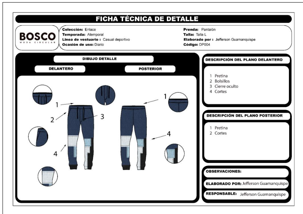
Figura 69: Ficha Técnica de Detalle DP004
