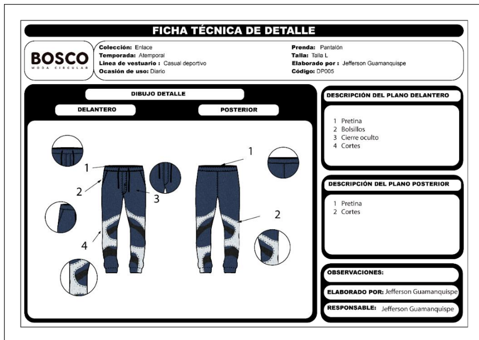
Figura 71: Ficha Técnica de Detalle DP005
