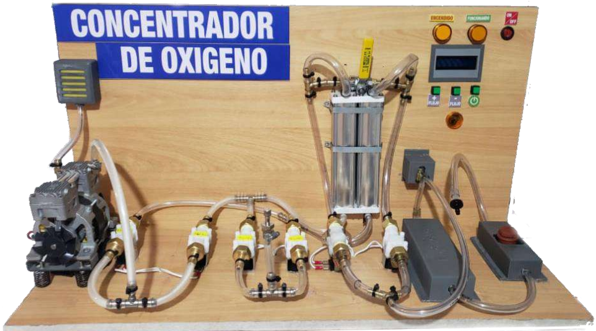
Figura 42. Banco de pruebas del equipo concentrador de oxígeno.
