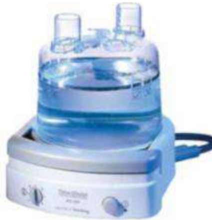
Figura 3. Humidificador caliente simple [8].
