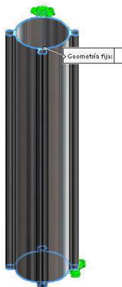
Figura 30. Extremos de la columna de adsorción fijados.
