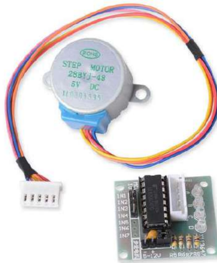
Figura 26. Motor a pasos 28BYJ-48 y controlador ULN2003A [46].
