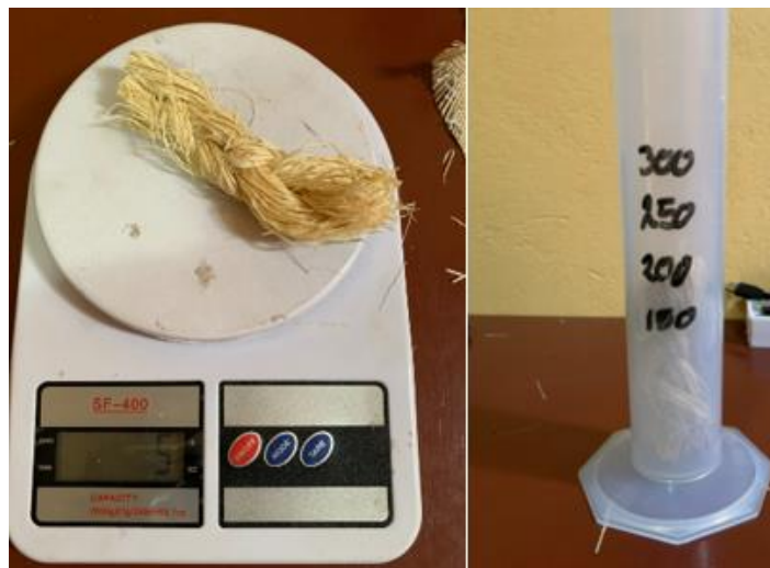
Figura 16: Calculo de la densidad de la fibra de chambira sin tejer
