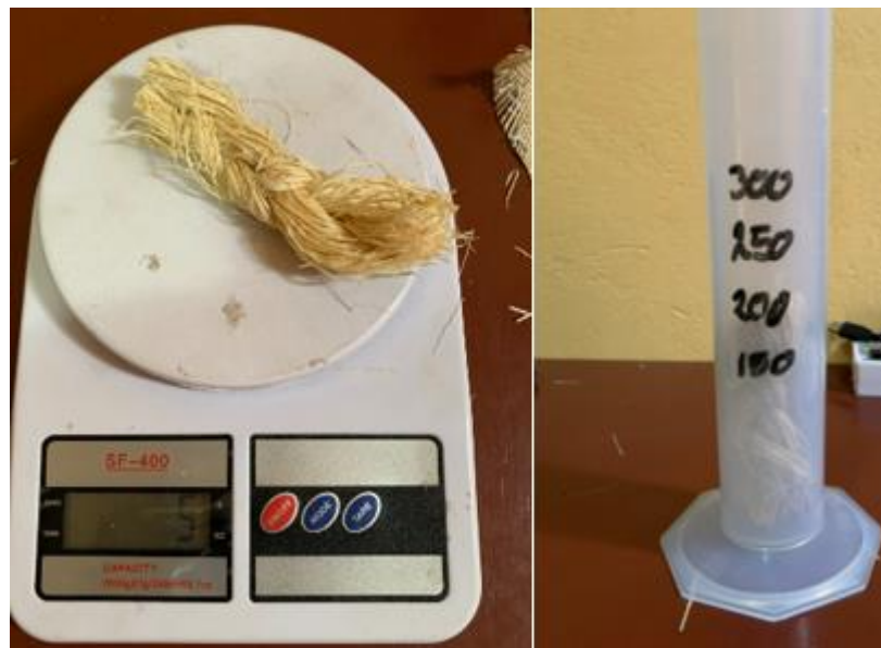
Figura 9: Cálculo de la densidad de la fibra de chambira sin tejer
