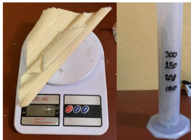
Figura 17: Calculo de la densidad de la fibra de chambira tejida
