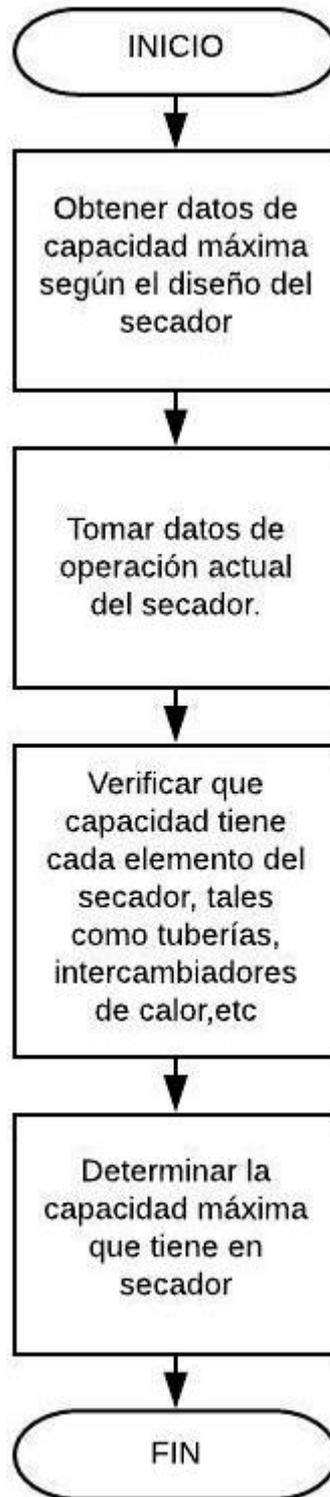
**Figura 11:** Procedimiento para determinar la carga máxima del secador
