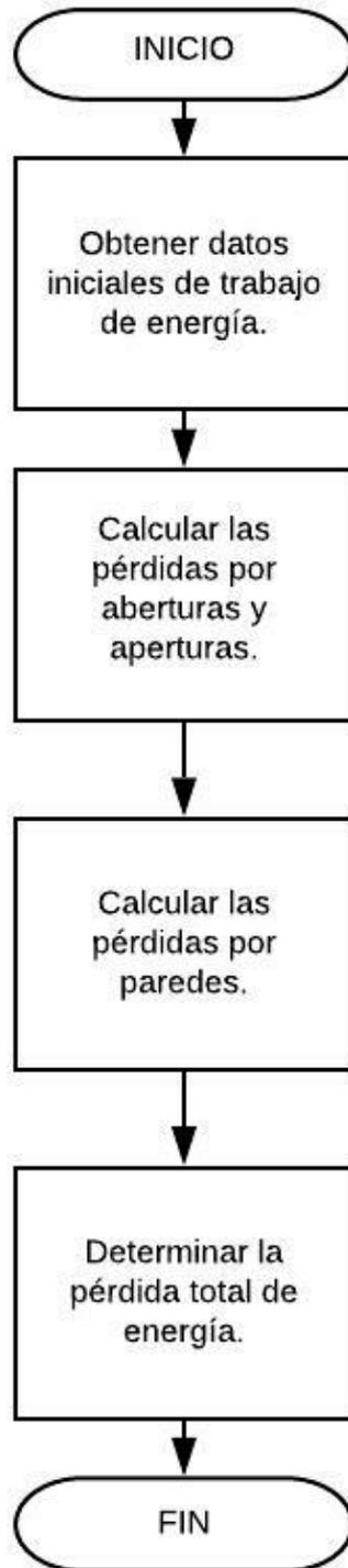
**Figura 13:** Procedimiento para el cálculo de pérdidas de energía
