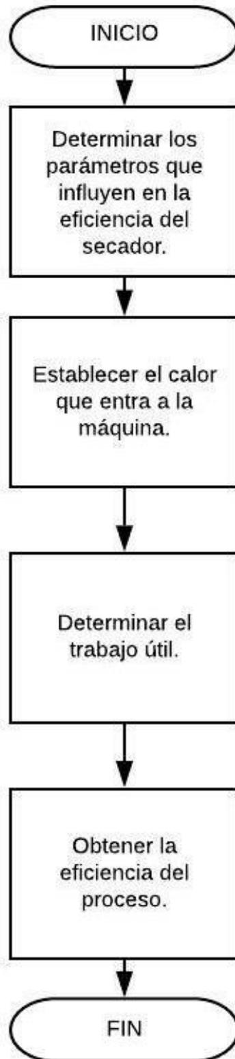
**Figura 14:** Procedimiento para determinar la eficiencia
