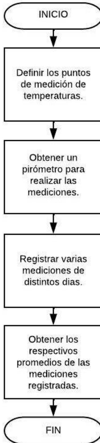
**Figura 12:** Procedimiento para tomar datos de temperaturas internas y externas
