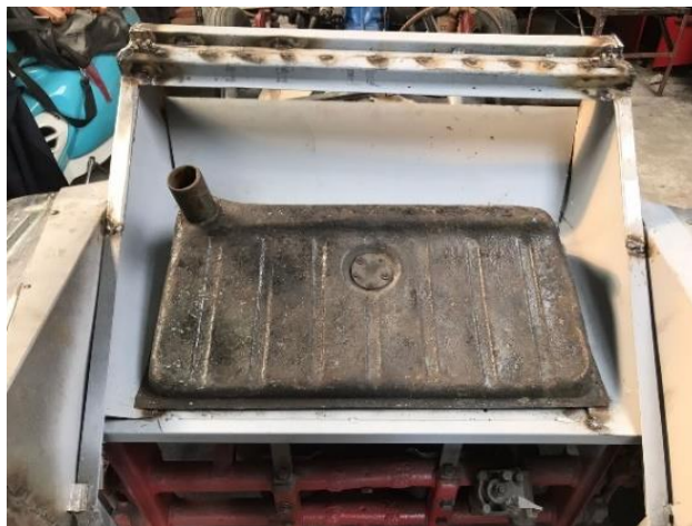
Figura 63.- Montaje de tanque de gasolina.
