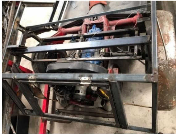
Figura 64.- Conformado de estructura de la parte trasera.
