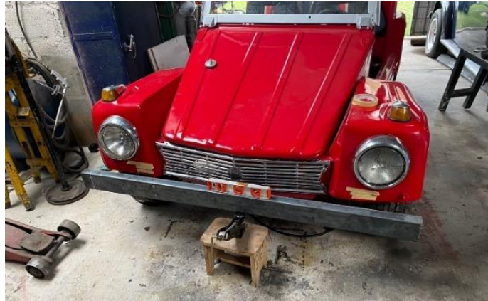
Figura 72.- Adecuación de guardachoque delantero.
