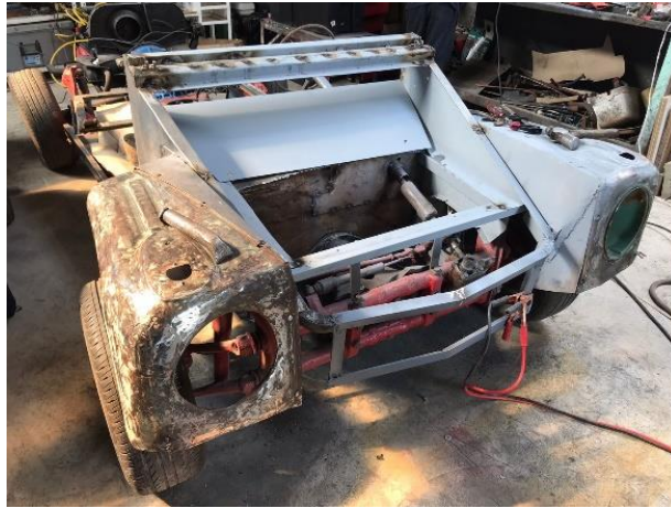
Figura 62.- Colocación de guardafangos.
