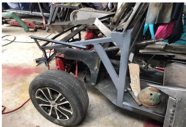
Figura 60.- Estructura delantera del vehículo.
