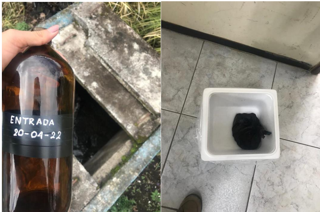
Figura 14. Toma de muestra del caudal de entrada de la PTAR Rumipamba Fuente: El autor Andrea Villacis
