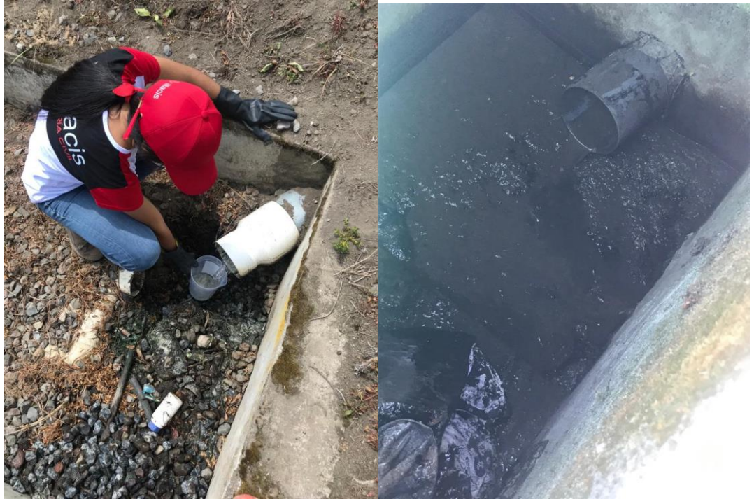
Figura 12.. Cierre de baypass para toma de caudales de entrada Fuente: El autor Andrea Villacis
