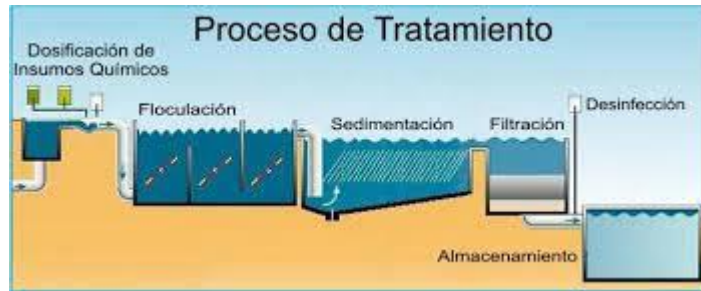
Figura 15.- Proceso de tratamiento para el agua
