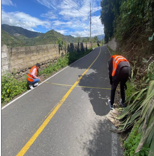
FOTOGRAFÍA 1: Medición de anchos de la carretera.
