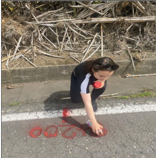
FOTOGRAFÍA 3: Identificación de las unidades de muestreo para la ejecución del PCI
