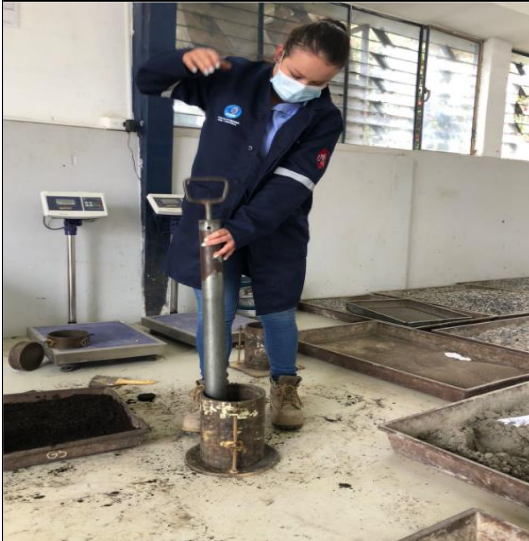
FOTOGRAFÍA 7: Ejecución del ensayo de proctor modificado.
