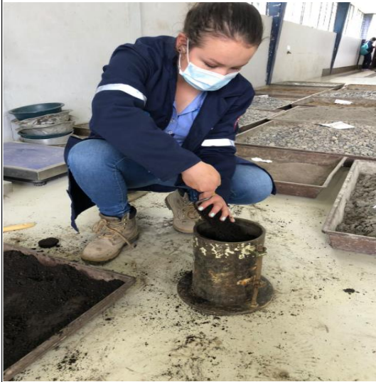
FOTOGRAFÍA 5: Colocación del suelo en el molde de proctor para su compactación .
