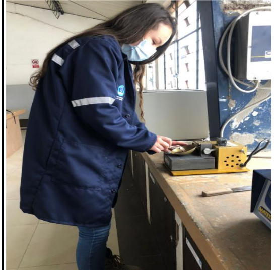
FOTOGRAFÍA 6: Ejecución del ensayo límite líquido.
