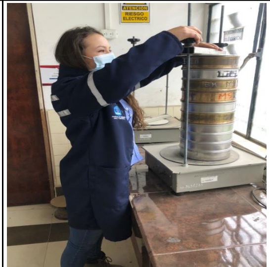
FOTOGRAFÍA 8: Uso del tamizador para el ensayo de granulometría .
