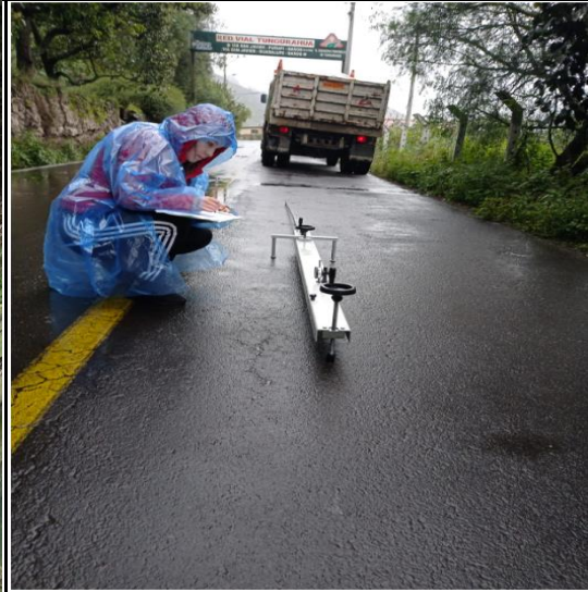
FOTOGRAFÍA 2: Toma de deflexiones en la capa de rodadura ABS 4+700
