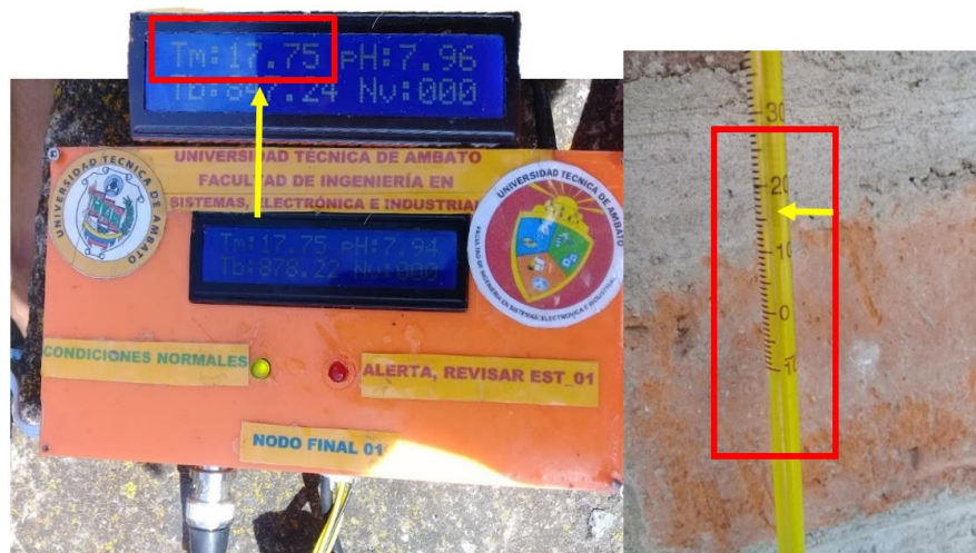
Figura 85: Comparación entre los valores de temperatura obtenidos por el prototipo y por el termómetro de vidrio.
