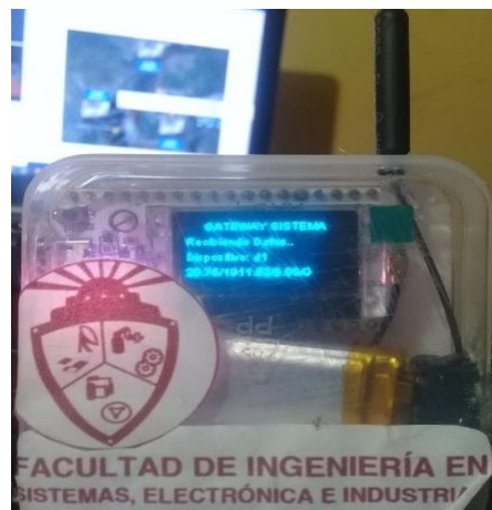
Figura 95: Gateway recibiendo datos de los nodos finales desde la estación base.
