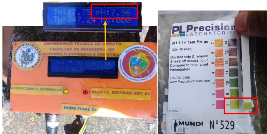
Figura 88: Comparación entre los valores de pH obtenidos por el prototipo y las tiras de papel.
