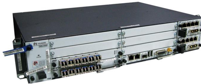
Figura. - 101 Estación base BBU
