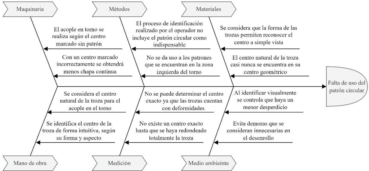
Fig. No. 53. Diagrama de Ishikawa del problema falta de uso de patrón circular
