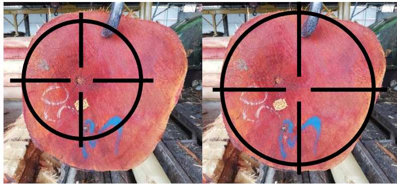
Fig. No. 42. Aprovechamiento de la troza según el centro natural y geométrico
