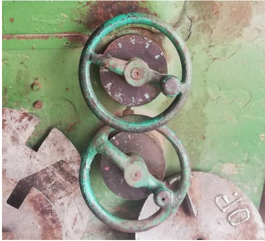
Fig. No. 26. Volantes para selección de espesor
