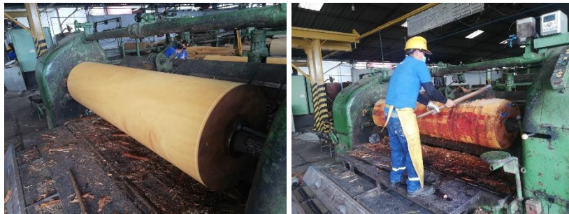
Fig. No. 51. Plato de agarre inadecuado
