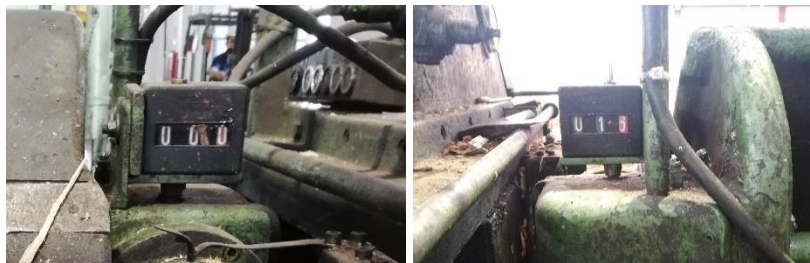
Fig. No. 41. Indicador de la abertura cuchilla–regle vista frontal y posterior
