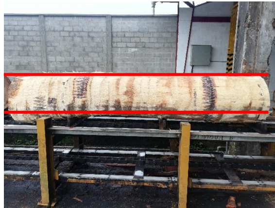
Fig. No. 45. Troza con defecto en la forma
