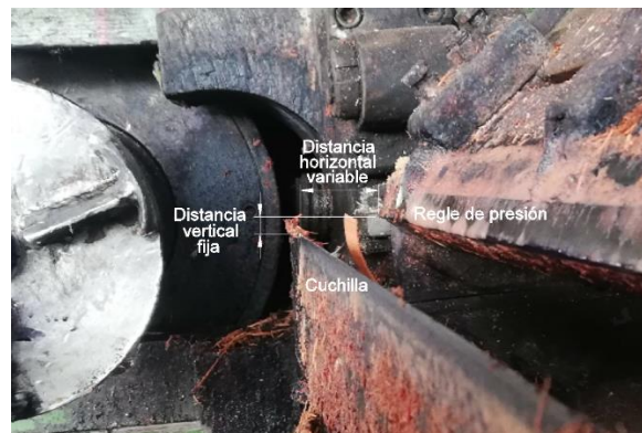
Fig. No. 38. Disposición cuchilla – regle de presión
