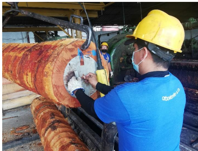
Fig. No. 44. Uso de patrón circular para identificación de centro geométrico
