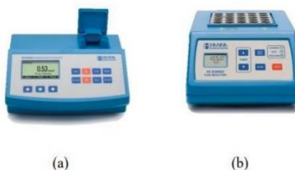
Figura 3. Equipo para determinación de DQO (a) Fotómetro multiparamétrico HANNA (b) Digestor HANNA
