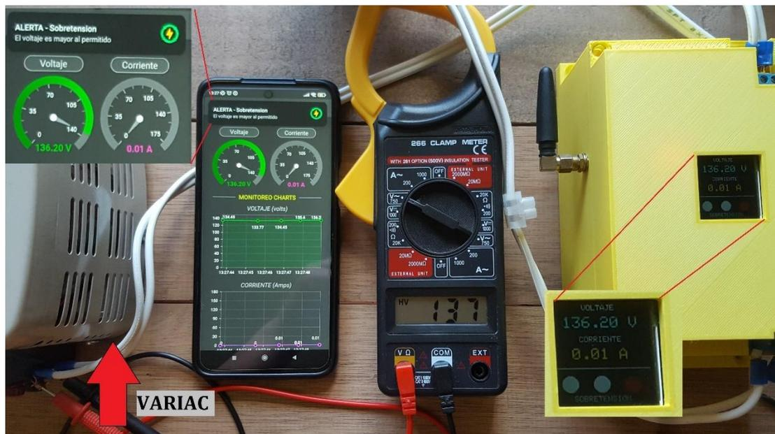
**Figura 62.-** Prueba de funcionamiento #1 con subidas de voltaje
