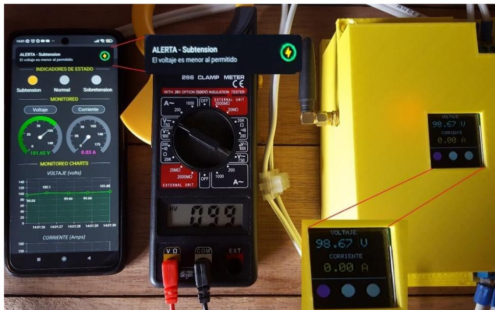
*Figura 59.- Prueba de funcionamiento #1 con bajadas de voltajes*
