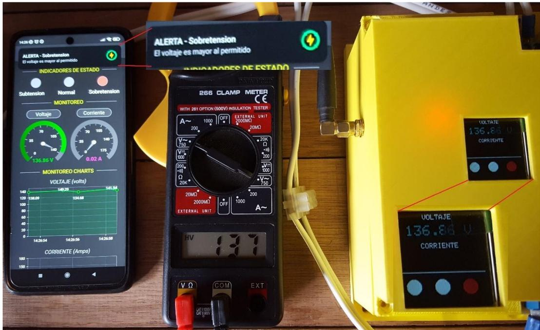
*Figura 63.- Prueba de funcionamiento #2 con subidas de voltaje*
