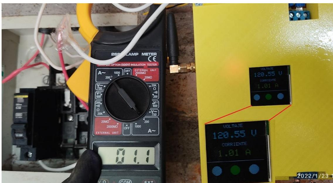
**Figura 53.- Medición de corriente con el prototipo en una residencia**
