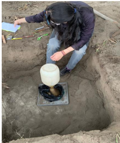
Figura 31. Ensayo densidad de campo
