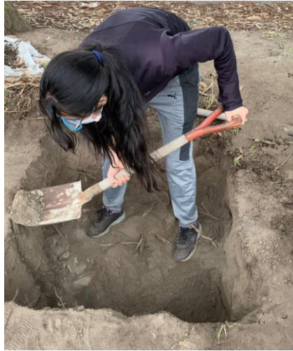
Figura 30. Excavación de calicata
