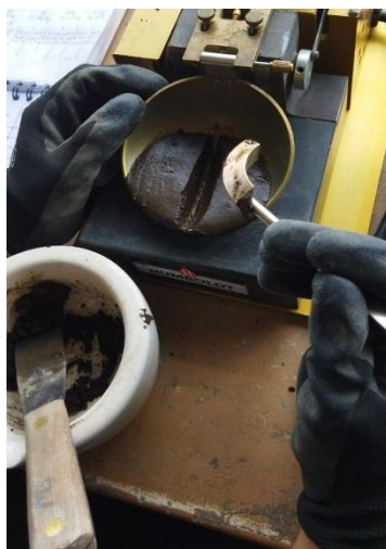
Muestra dividida en copa Casagrande para limite líquido
