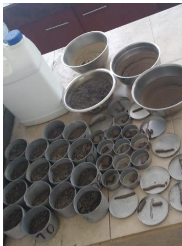
Figura 112. Muestras secas (Contenido de humedad, gravedad específica, límite líquido y límite plástico)
