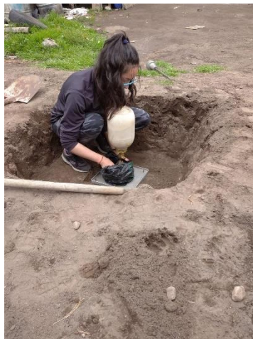
Figura 109. Realización de ensayo densidad de campo
