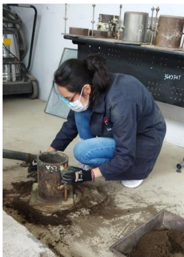
Figura 113. Retiro de collarín, ensayo Proctor
