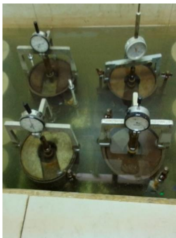
Figura 115. Colocación de muestras en curado, ensayo CBR
