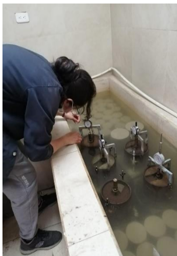
Figura 116. Colocación de diales para lecturas de esponjamiento, ensayo CBR
