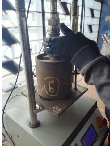
Figura 117. Realización de ensayo CBR
