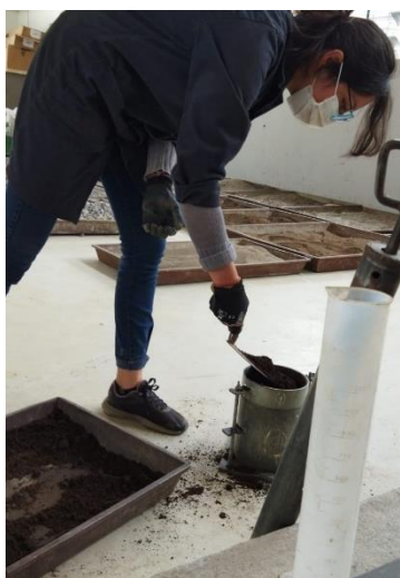
Figura 114. Colocación de muestra en molde para ensayo CBR
