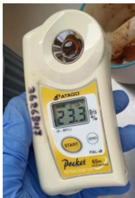
**Figura 6.** Refractómetro ATAGO
