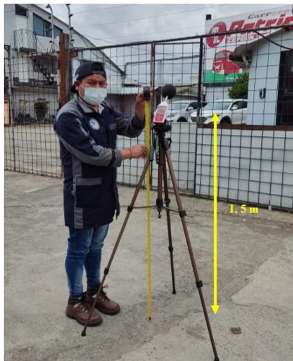
Figura 22. Ubicación del sonómetro a una altura de 1,5 m a partir del suelo.
