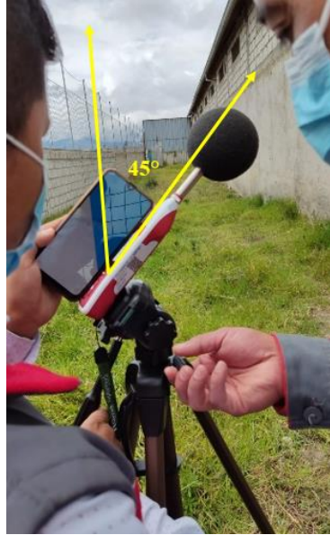
Figura 23. Verificación del ángulo del sonómetro.
