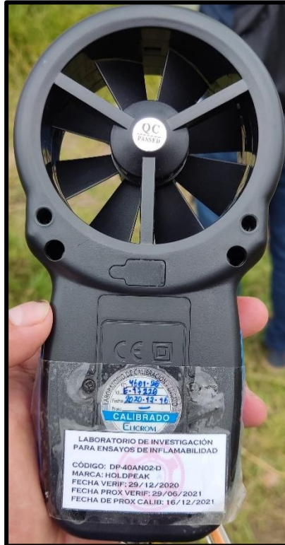
Foto 4. Especificaciones del anemómetro.
