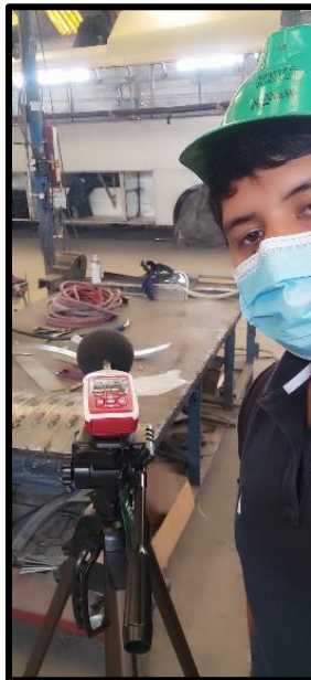
Foto 20. Medición a 5 metros ensamblador.
