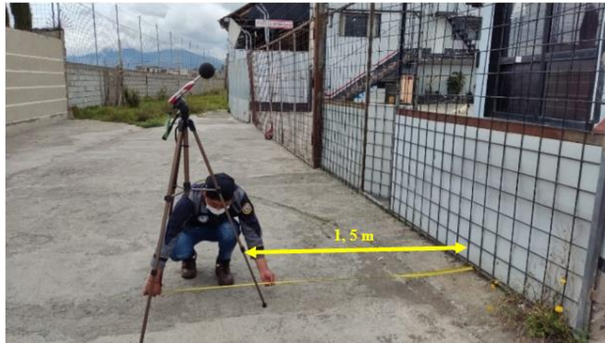
Figura 21. Ubicación del sonómetro a 1,5 m fuera del lindero de la empresa.
