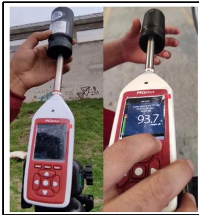
Foto 13. Calibración del sonómetro a 93,7 dB.
