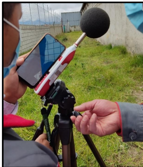
Foto 5. Ajuste a 45 ° del sonómetro
