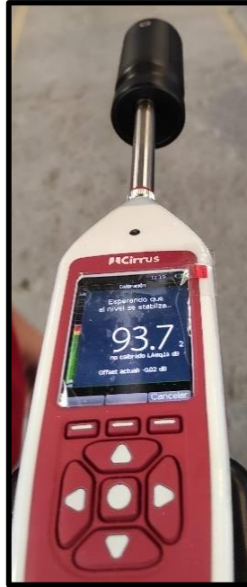
Foto 14. Calibración del sonómetro 93,78 dB
