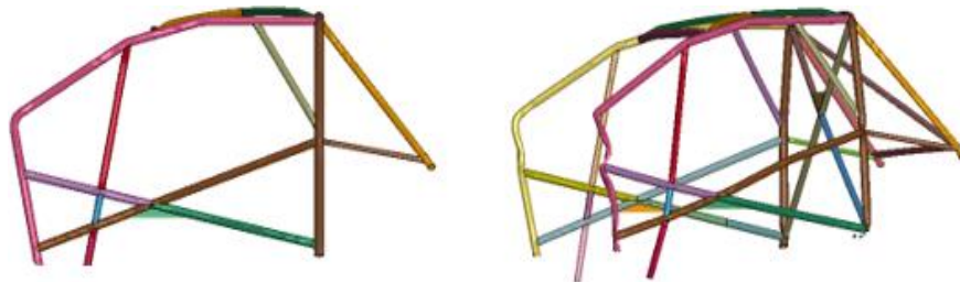
Figura 88. Deformación final de la jaula de seguridad.
