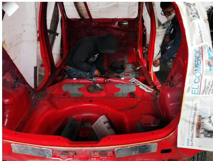
Figura 113. Preparación de la carrocería interna del vehículo.
