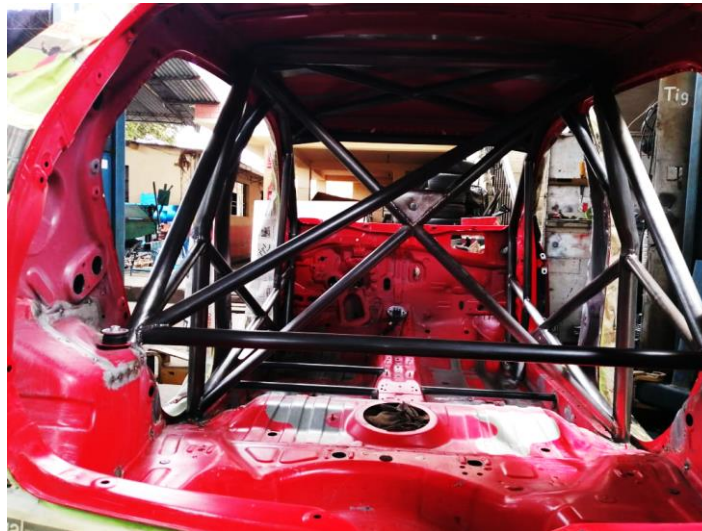
Figura 117. Tirantes posteriores y refuerzos soldados a la parte superior de la suspensión posterior.
