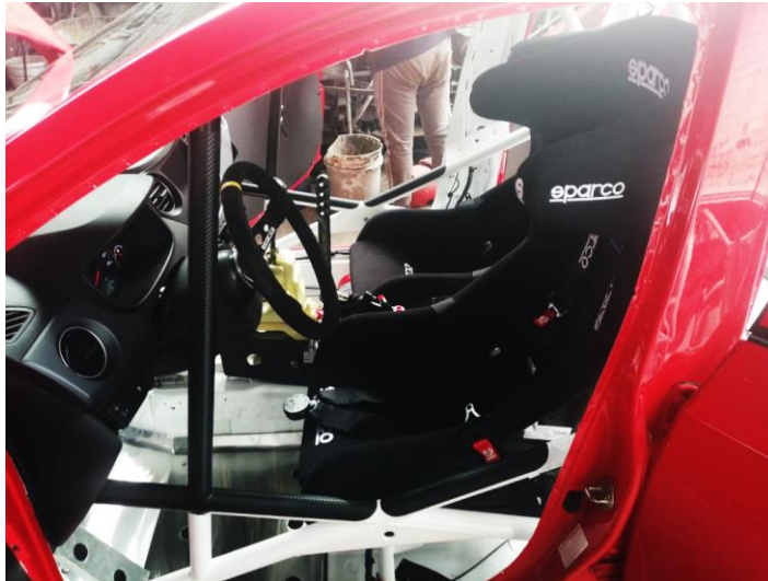
Figura 124. Tablero, volante y asientos de rally.
