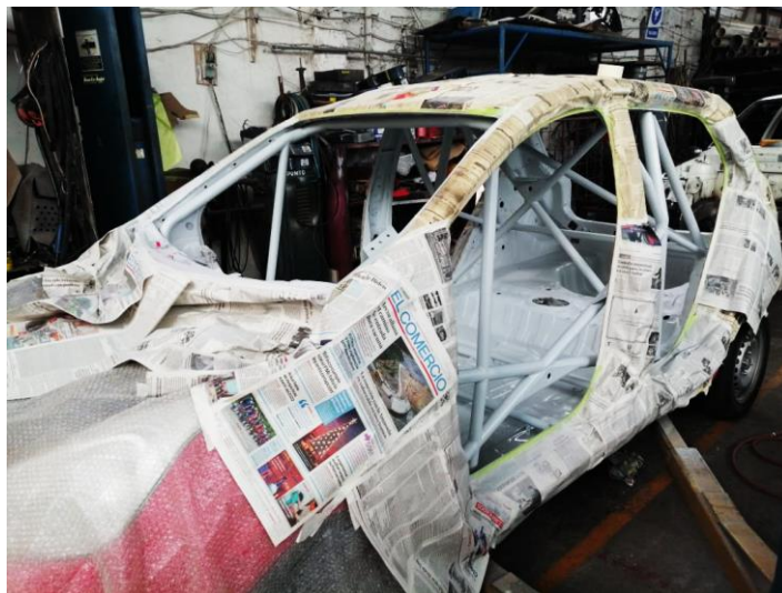
Figura 121. Pintado del interior del vehículo y la estructura de la jaula de seguridad.
