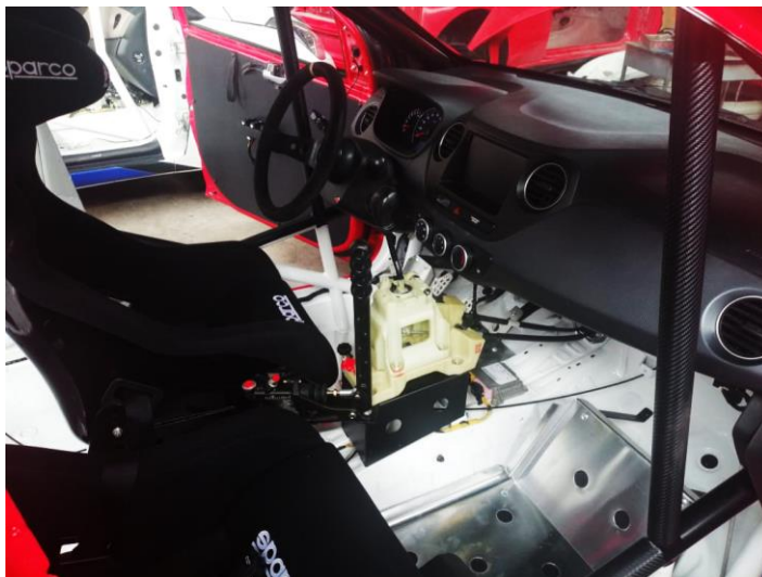
Figura 125. Sistema eléctrico y de transmisión.
