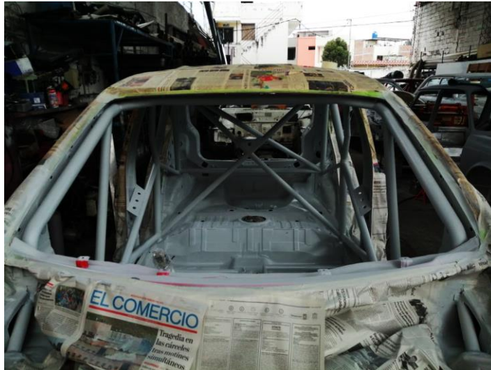
Figura 122. Vista frontal del pintado de la estructura d seguridad.
