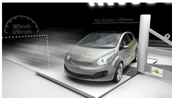
Figura 31. Esquema de impacto lateral con poste [33].
