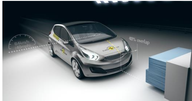
Figura 30. Esquema de impacto frontal con barrera fija [31].
