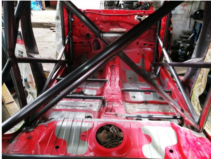
Figura 118. Puntos de anclaje soldados a la carrocería interna del vehículo.
