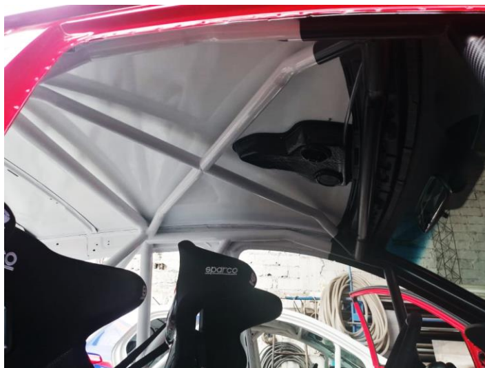
Figura 128. Sistema de ventilación instalada en el techo.
