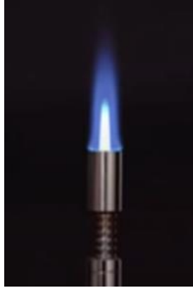
Fig. 2.4.2. Llama color azul combustión completa.
