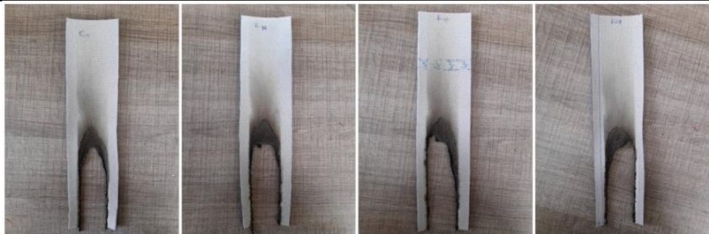
Fig. 3.3.10 Tejido navalhado después del ensayo de inflamabilidad.
