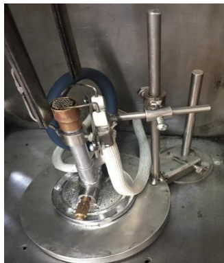
Fig. 2.2.6. Base del mechero y porta electrodos con movimiento vertical y alrededor de su eje.
