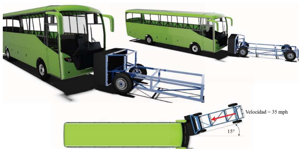
Figura 23: Procedimiento de simulación de impacto oblicuo con barrera móvil producido en el conductor.
