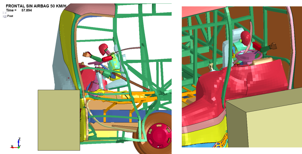
Figura 32: Impacto frontal de autobús con barrera fija.
