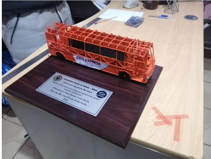
Figura 115: Modelo de estructura de autobús impreso en 3D.
