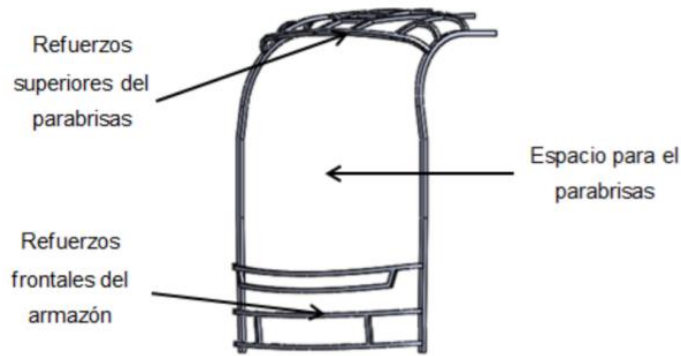
Figura 2: Estructura de la cabina [17].
