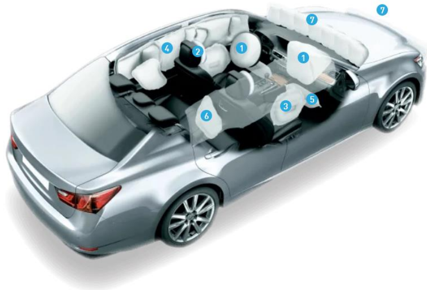
Figura 8: Disposición de las bolsas de aire en un vehículo [24].
