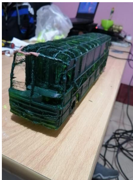
Figura 114: Estructura a escala de autobús impreso en 3D.
