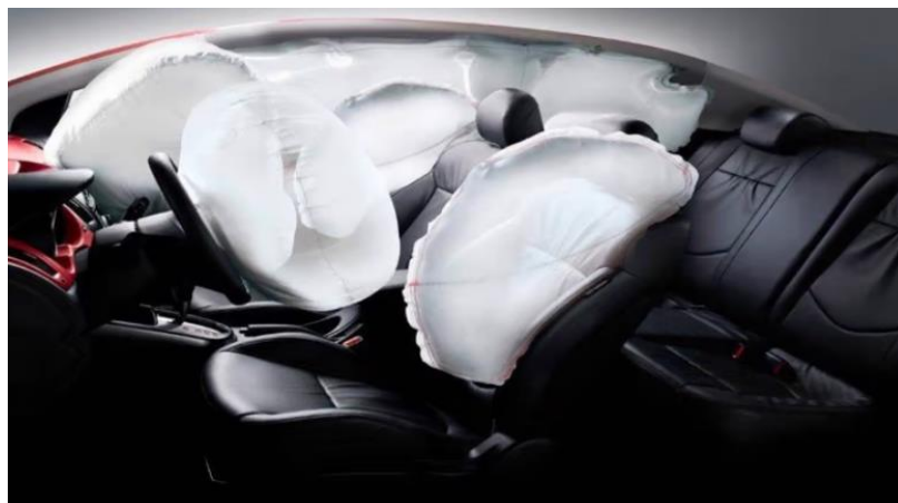
Figura 6: Despliegue de las bolsas de aire [19].
