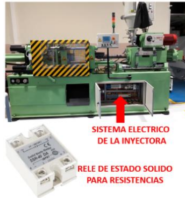
Figura 2: Sistema eléctrico de la máquina inyectora de plástico.
