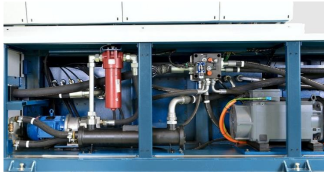
Figura 1: Sistema hidráulico de la máquina inyectora de plástico.
