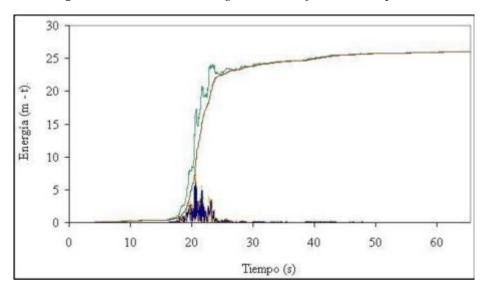
Figura 1. Balance de energía en un edificio sin disipadores
