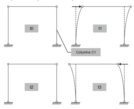
Figura 13. Comportamiento de un pórtico antes una acción sísmica
