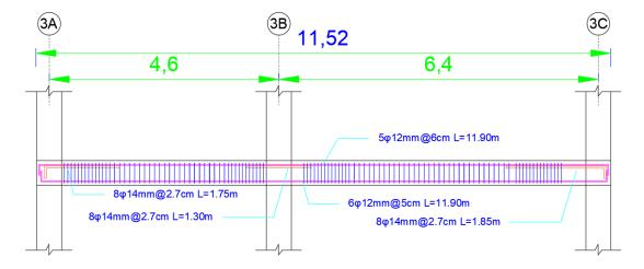
Figura 94. Armado de viga (Eje X)
