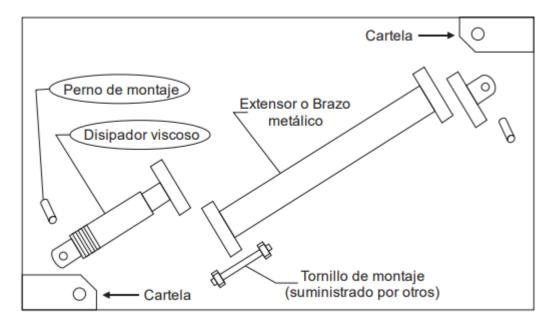
Figura 17. Conexiones de disipadores viscosos
