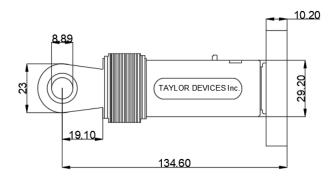
Figura 89. Diseño de disipador para el eje Y, Fuerza 74.22 tonf.
