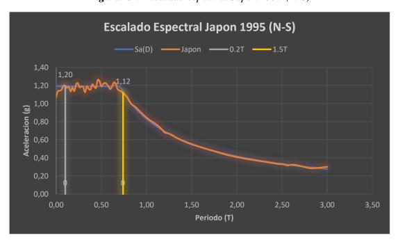
Figura 67. Escalado espectral Japón 1995 (N-S)
