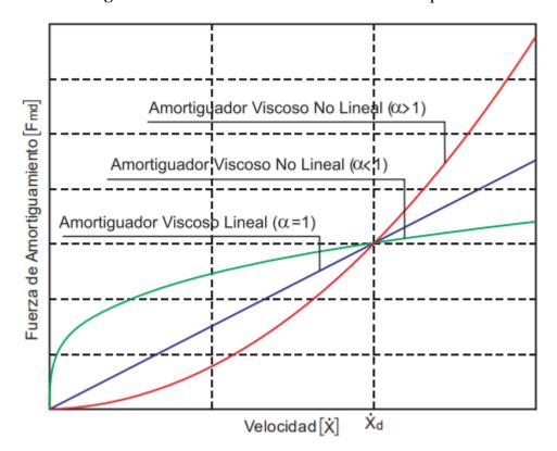
Figura 12. Relación velocidad vs fuerza del disipador
