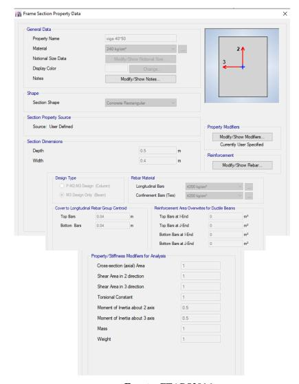
Figura 37. Definición de vigas de acuerdo a software de diseño
