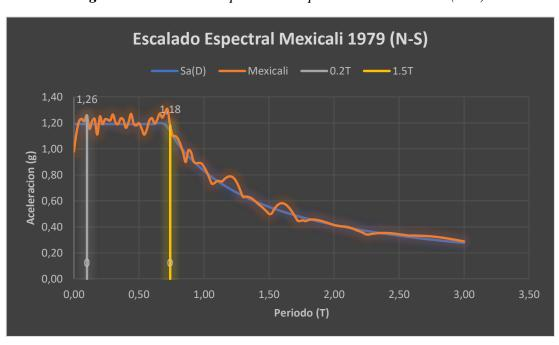
Figura 65. Escalado espectral aeropuerto Mexicali 1979 (N-S)
