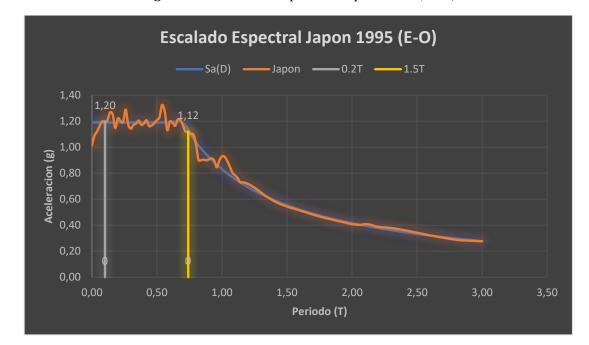
Figura 68.Escalado espectral Japón 1995 (E-O)
