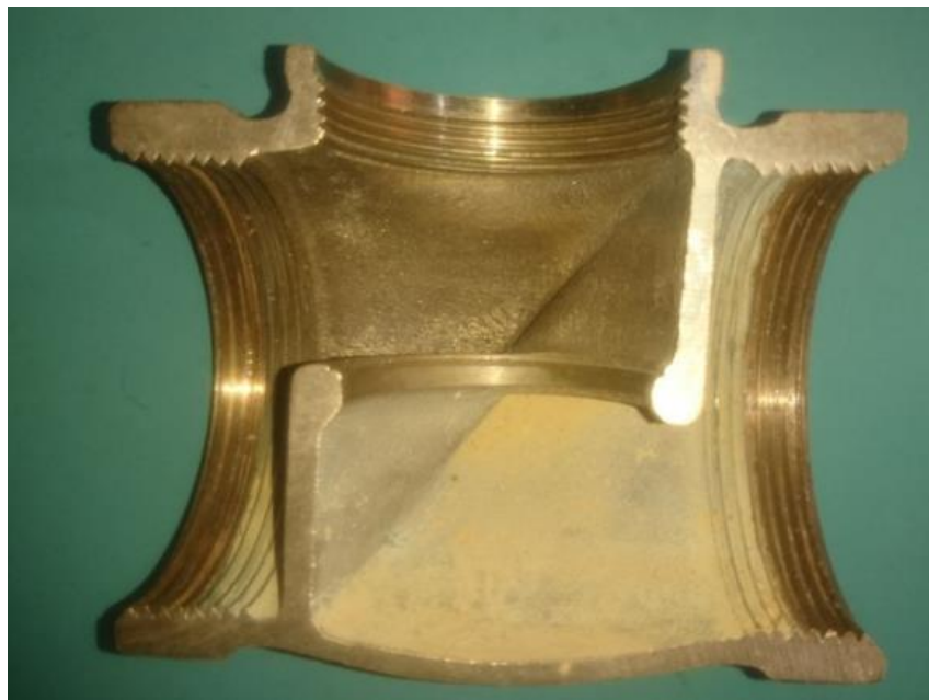
Figura 3.1 Válvula de globo de Cuerpo de \phi 50 , se muestra la válvula de globo en corte transversal, lado derecho ingresa el fluido.
