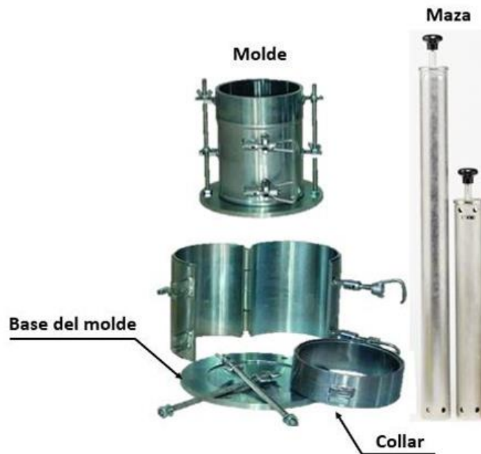
Gráfico 1. 57. Equipamiento de laboratorio para ensayo Proctor
