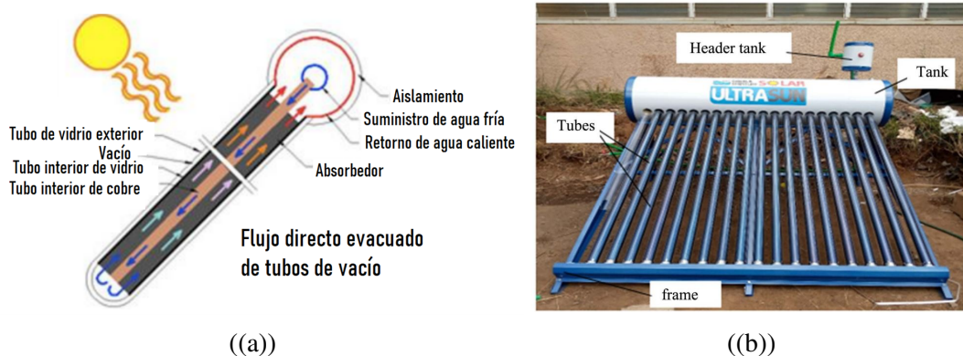
Figure 2.1: (a) muestra el tubo de vidrio interior de menor diámetro recubierto selectivamente para la absorción de la radiación solar dentro del tubo de vacío. (Gholami et al., 2020) y la Figura 2.1 (b) muestra el montaje experimental del calentador de agua solar de tubo de vacío de agua con tubo de vacío (Kyekyere et al., 2021)
