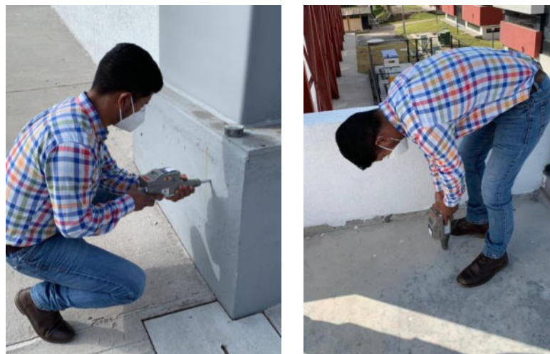
Figura 39: Ejecución del ensayo esclerómetro – Taller FICM
