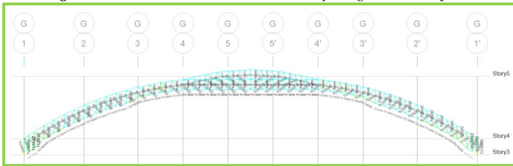
Figura 92. Diseño de Cordones, Montantes y Diagonales del Eje G.
