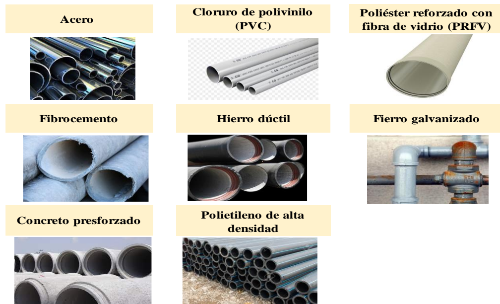
Figura 3. Materiales de las tuberías.
