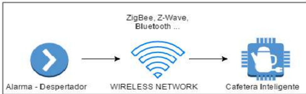
Figura 1.5: Modelo de comunicación dispositivo-dispositivo [44]
