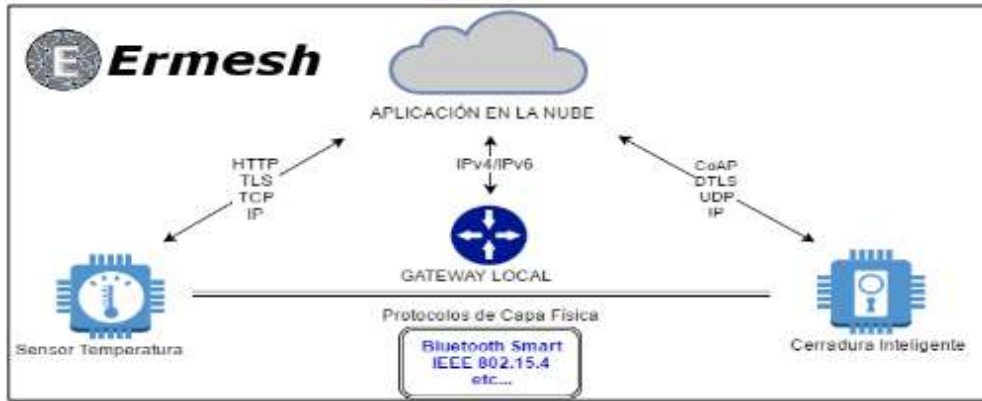
Figura 1.7: Modelo de comunicación dispositivo-gateway [44]
