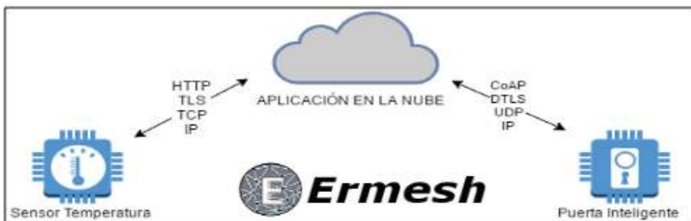
Figura 1.6: Modelo de comunicación dispositivo-Internet [44]
