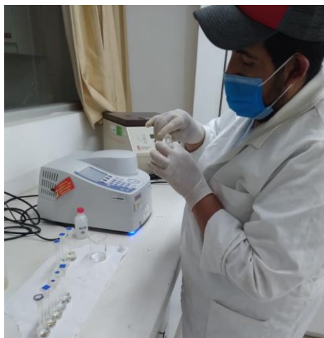
Figura 10. Soluciones estándares con las concentraciones establecidas, para elaborar la curva de calibración de ácido sórbico y ácido benzoico. Materiales usados en LACONAL
