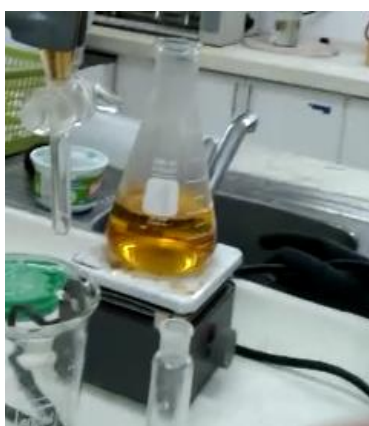
Figura 12. Pretratamiento de la muestra colocada en la plancha de calentamiento, para la eliminación del CO 2 . Materiales y equipos usados en laboratorio LACONAL.
