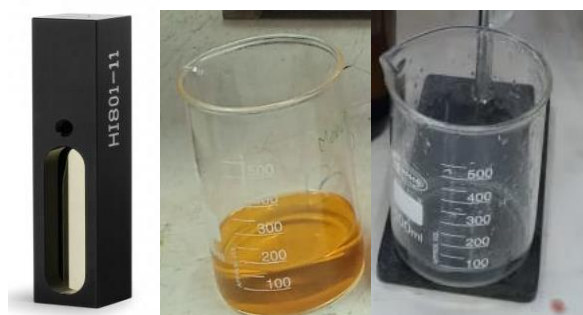
Figura 9. Celda de holmio, solución estándar de dicromato de potasio y solución estándar de cloruro de potasio para calibración del espectrofotómetro. Materiales usados en laboratorio LACONAL.
