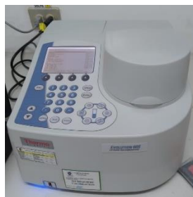
Figura 7. Espectrofotómetro “Thermo Scientific EVOLUTION 60S” usado para determinar la absorbancia de las muestras de bebidas azucaradas. Equipo usado en laboratorio LACONAL.
