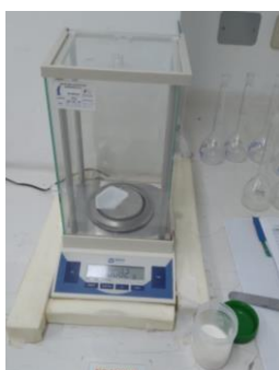
Figura 15. Balanza analítica usada para el pesado de los reactivos utilizados en el método de adición de estándar. Equipo usado en LACONAL.
