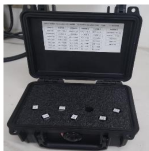
Figura 8. Kit de celdas “spectronic Standards 2 SN: SA0996 Calibration Data Summary” para calibración del espectrofotómetro en rango visible. Kit usado en laboratorio LACONAL.
