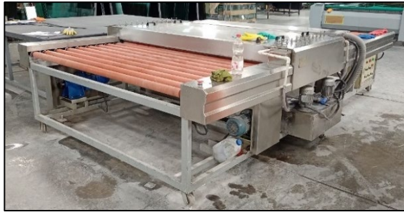
Figura 88. Máquina empleada para el proceso de lavado Fuente: SEGUVID
