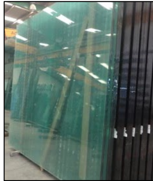
Figura 3. Ejemplo de plancha de vidrio flotado [27].
