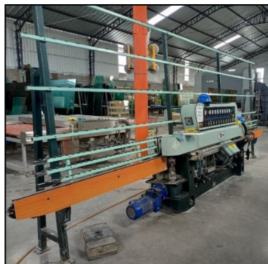
Figura 86. Máquina empleada en el proceso de pulido Fuente: SEGUVID
