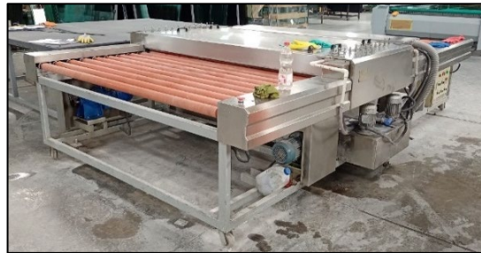
Figura 8. Máquina de lavado de vidrio Fuente: SEGUVID
