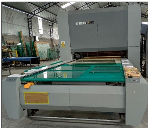
Figura 89. Horno utilizado para realizar el proceso de templado Fuente: SEGUVID
