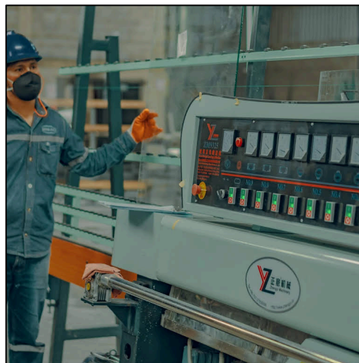
Figura 7. Máquina de pulido de vidrio. Fuente: SEGUVID
