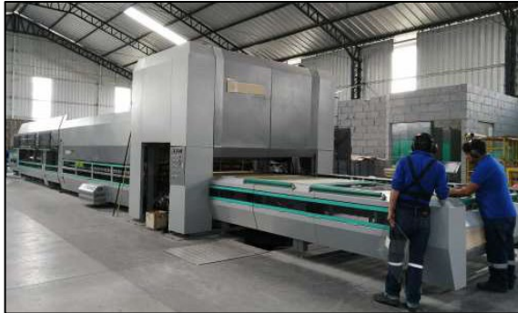
Figura 9. Horno horizontal de templado de vidrio Fuente: SEGUVID
