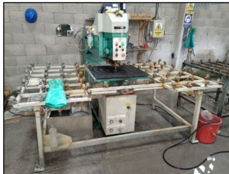
Figura 87. Máquina utilizada para el proceso de perforado Fuente: SEGUVID
