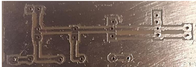
Figura 25.- Diagrama del circuito en baquelita.
