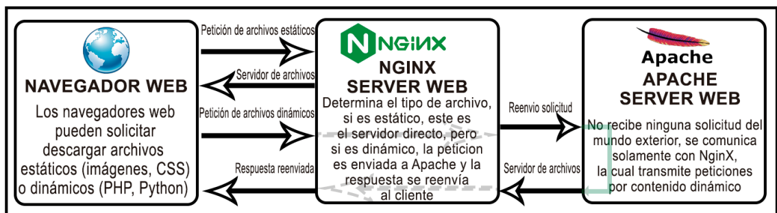
Figura 6 Modelo de comunicación de Nginx[21]
