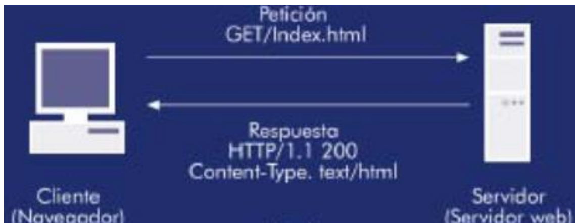
Figura 4 Esquema de la petición y respuesta HTTP[17]
