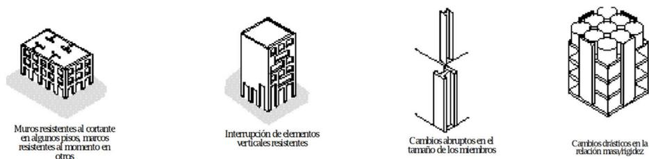
Figura 17. Edificios con cambios abruptos en su rigidez lateral [21].
