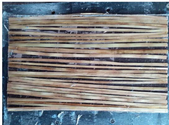
Figura 3. 8. Material compuesto secado listo para sacarlo. Fuente: El autor
