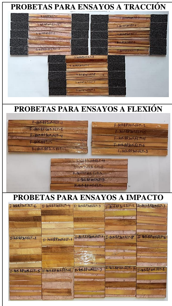
Figura 3. 9. Probetas para ensayos a tracción, flexión e impacto. Fuente: El autor
