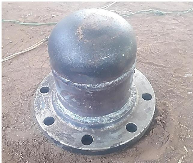
**Figura 3. 11** Armado del cabezal
