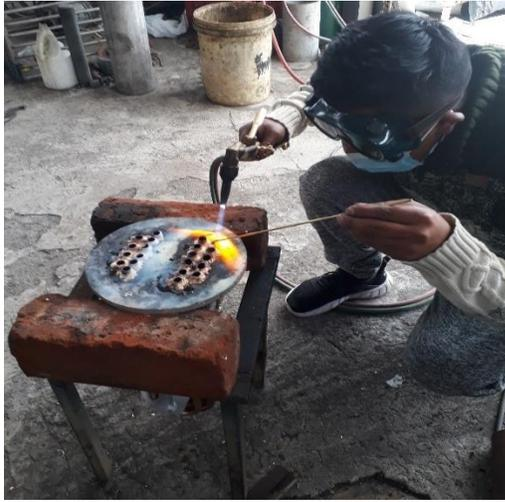
**Figura 3. 14** Soldado de tubos de cobre con el espejo
