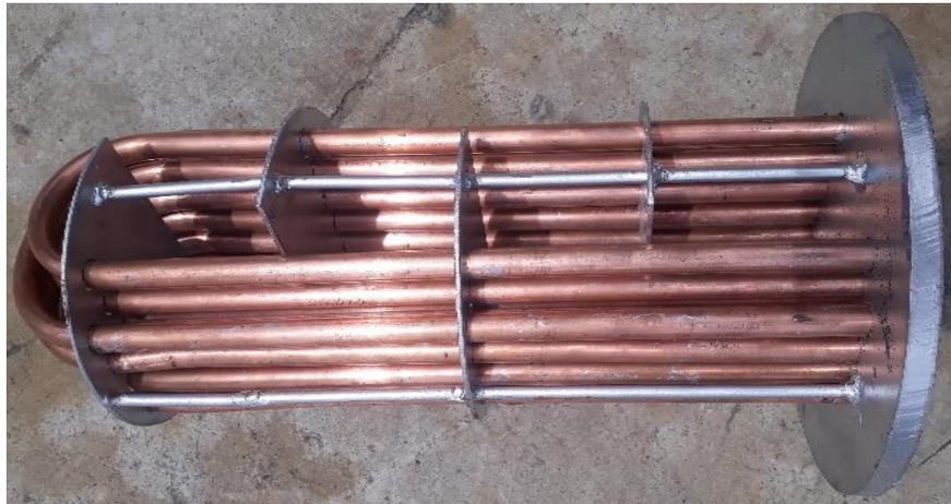
**Figura 3. 12** Armado del sistema de tubos
