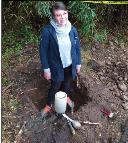
Fig. 19: Determinación de la densidad de campo
