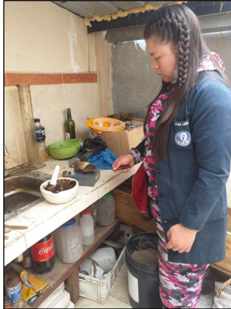
Fig. 23: Colocación del suelo en la Copa de Casagrande
