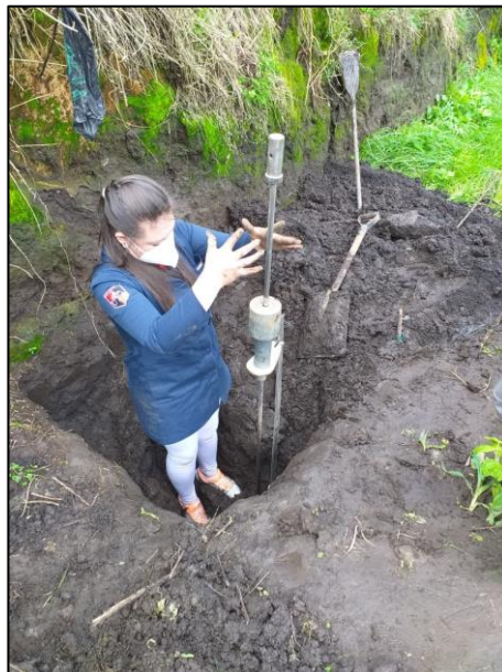
Fig. 20: Golpes para la penetración del DCP
