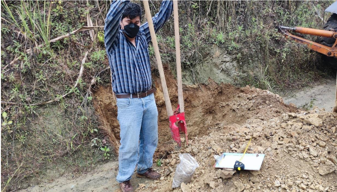
Extracción de muestra para la clasificación SUCS de la ABS. 1+000
