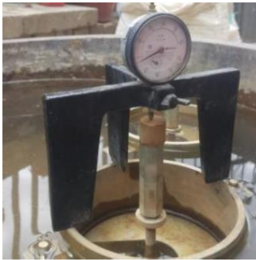
Anexo 13. Trípode con medidor expansión
