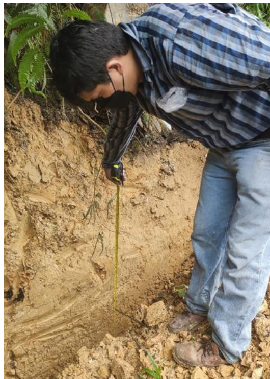
Comprobacion de nivel de -1.50m para extracción de la muestra de la Sub-Rasante de la ABS. 2+000
