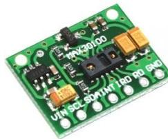
El dispositivo MAX30100 permite la adquisición de datos de saturación de oxígeno en la sangre y de pulsaciones por minuto del corazón, es de tamaño reducido que ayuda al manejo e implementación en un case adaptable para el dedo.
