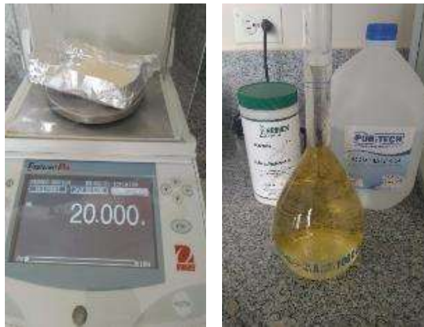
Foto 1. Preparación del agua peptonada (pesaje del polvo y añadidura de agua destilada, para posterior esterilización en autoclave).
