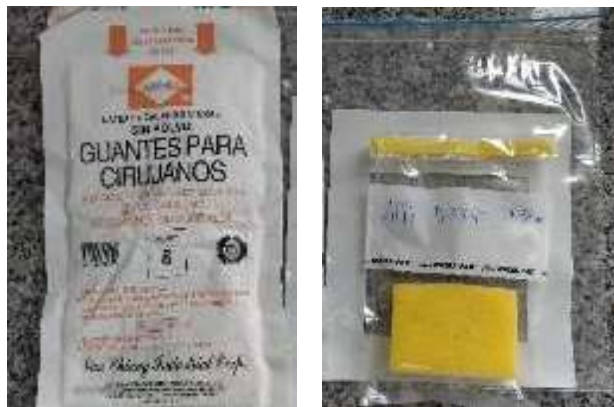
Foto 2. Elementos esterilizados. Guantes quirúrgicos, marco de plástico de un solo uso y esponja Whril-pack con la identificación de la muestra (número de muestra, fecha y hora).
