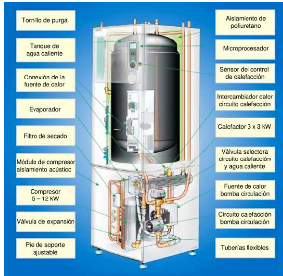
Figura 1.20 Bomba de calor. [22]
