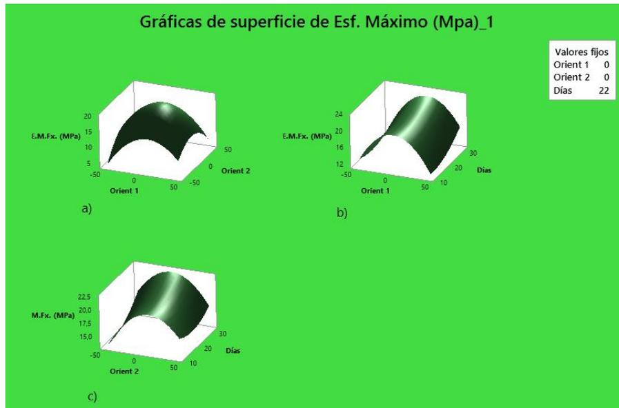
Figura 3.27: Análisis de superficie de respuesta para el Esfuerzo máximo a flexión [Minitab].
