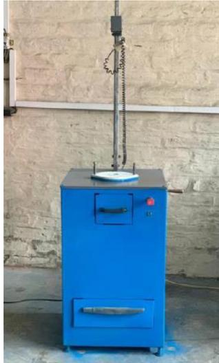
Figura 2.8: Ensayo de impacto [Autor]
