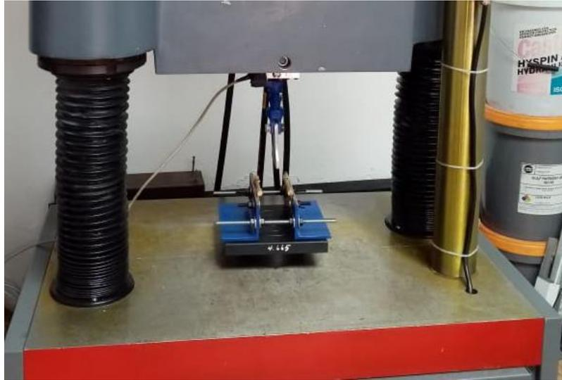
Figura 1.11: Máquina universal de ensayos - WAW600B [Autor].
