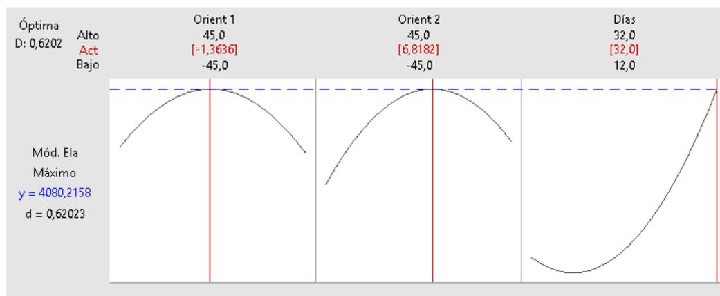
Figura 3.14: Análisis de optimización para el Módulo de elasticidad a tracción [Minitab].
