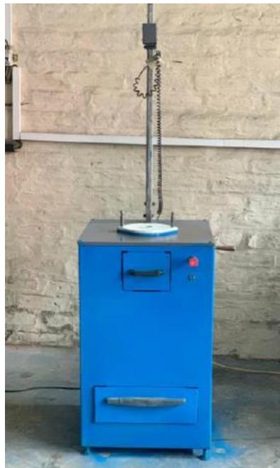
Figura 1.12: Máquina tipo caída de masas de impacto [Autor].
