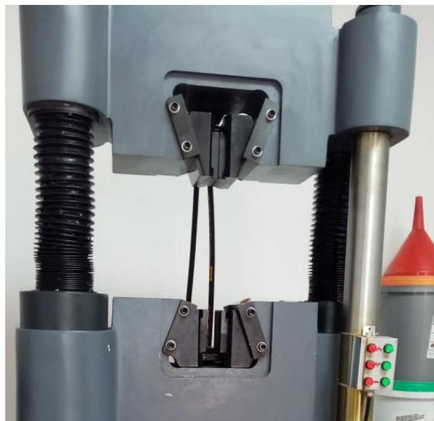
Figura 1.10: Máquina universal de ensayos - WAW600B [Autor].
